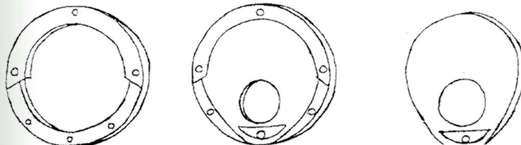
Le dispositif ci-dessus permet de rétrécir l'entrée des cavités tout en permettant à l'ornithologue d'y accéder (entretien, baguage, etc.).
